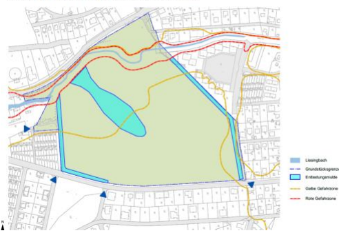
Entwässerung - Starkregen - geplant: Kontrolle durch Mulden
